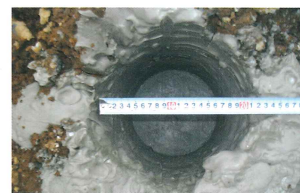
掘り起こしたピュアパイルとその断面
