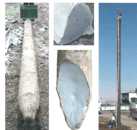
掘り起こしたピュアパイルとその断面
